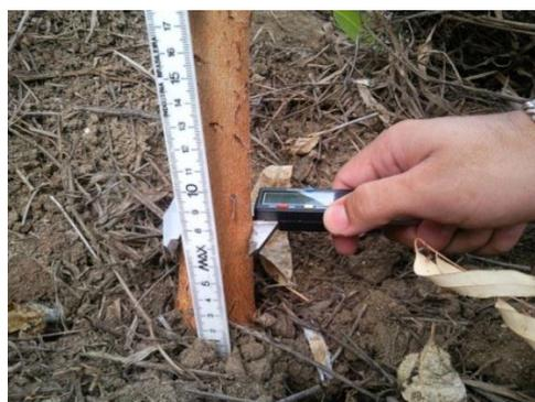
**Figura 6.** Medição do diâmetro a 7 cm do solo
