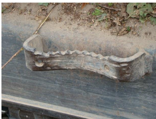
Figura 5 - Pedal danificado durante a operação de colheita
