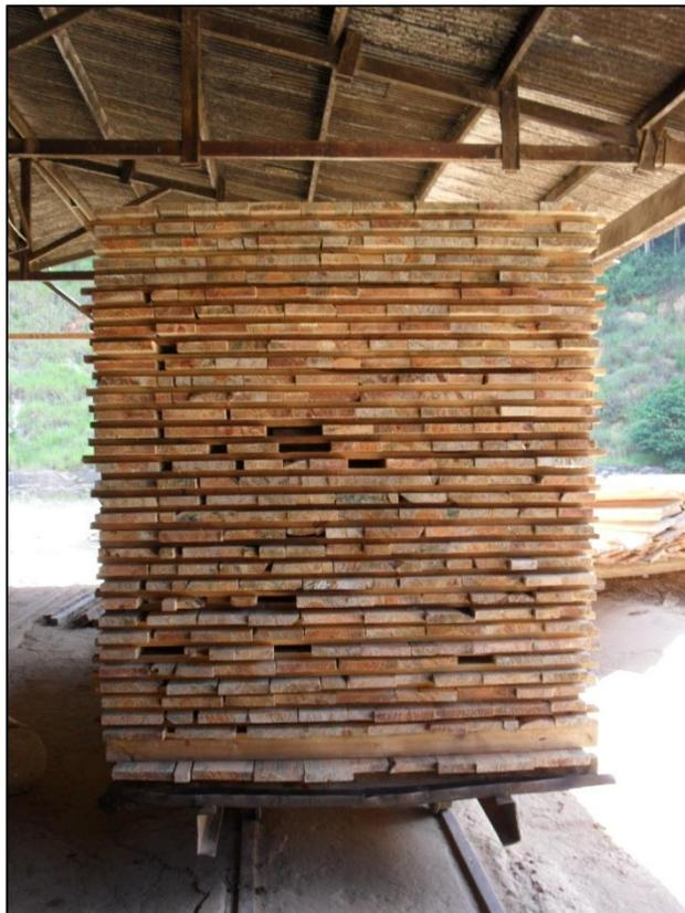
Figura 7 – Carga pronta sobre um dos vagonetes.
