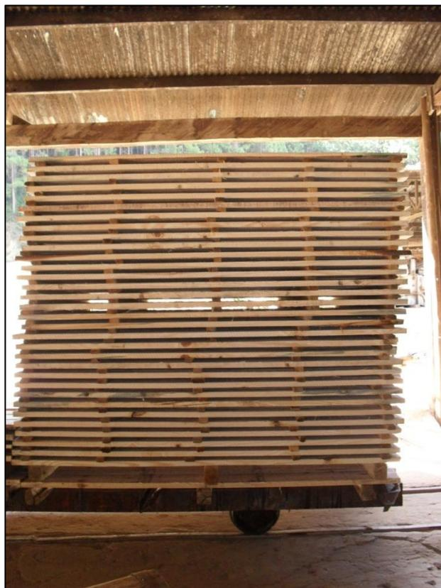
Figura 6 – Visão lateral da carga empilhada sobre um dos vagonetes.
