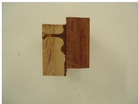
Figura 1 – Corpo de prova utilizado no ensaio de cisalhamento por compressão na linha de cola.
