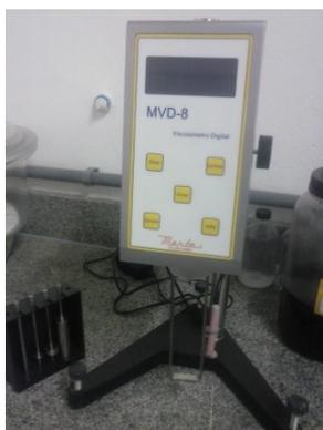
Figura 6 – Viscosímetro digital para obtenção da viscosidade dos adesivos.
