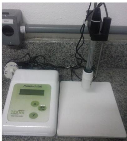
Figura 5 - pHmetro utilizado para medição do pH dos adesivos. Fonte: o autor.
