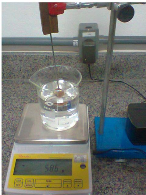
Figura 2 – Submersão dos corpos de prova em água para obtenção do volume visando a determinação da densidade básica. Fonte: o autor.
