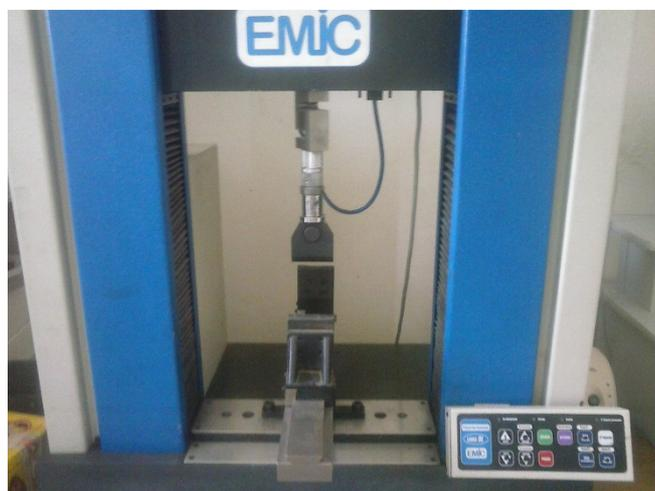
Figura 4 – Máquina de ensaios com tomada automática de dados. Fonte: o autor.
