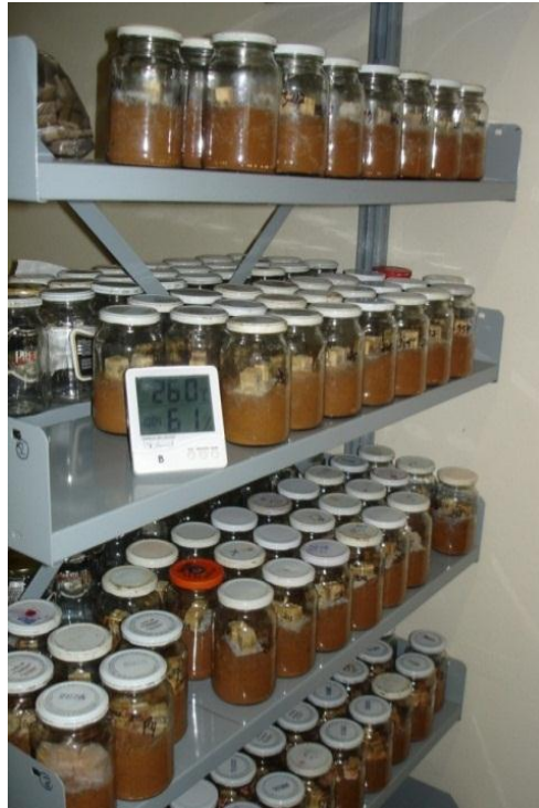
Figura 3 - Frascos inoculados, com os corpos de prova durante o ensaio.
