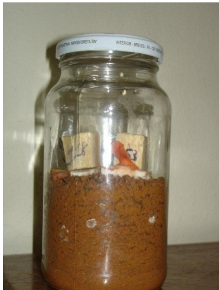
Figura 2 - Fungos desenvolvidos, com os corpos de prova do experimento.
