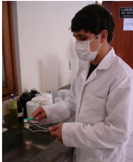
Figura 5 - Corpos de prova sendo limpos para a retirada do micélio dos fungos.
