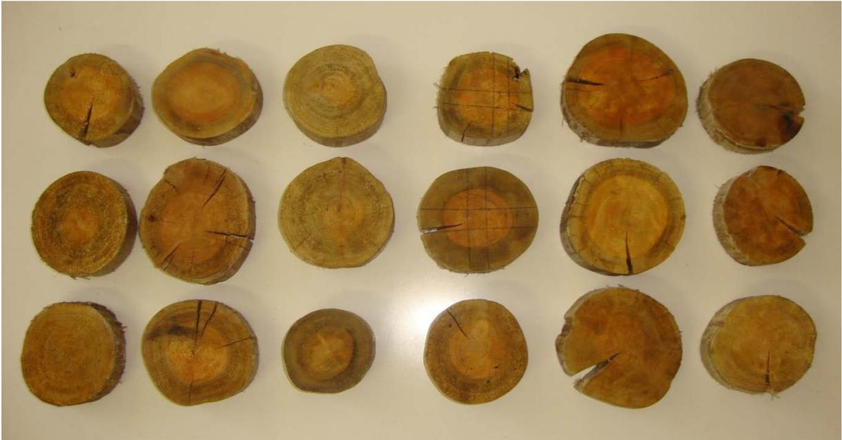
Figura 3 – Reação colorimétrica para o elemento boro
