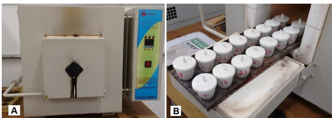
Figura 1 - Obtenção do teor de cinzas por meio da incineração dos resíduos (A: forno mufla; B: cadinhos de porcelana).
