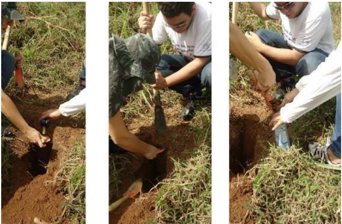
Figura 3 - Medição da profundidade e retirada da amostra no perfil do solo. Depois de retirada, a amostra é armazenada em saco plástico e levada para análise Fonte: autor.
