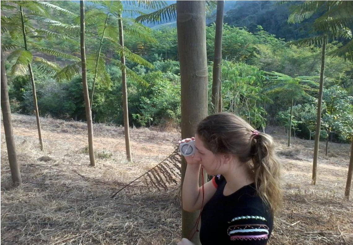
Figura 3: Medição da altura total com uso do clinômetro eletrônico.
