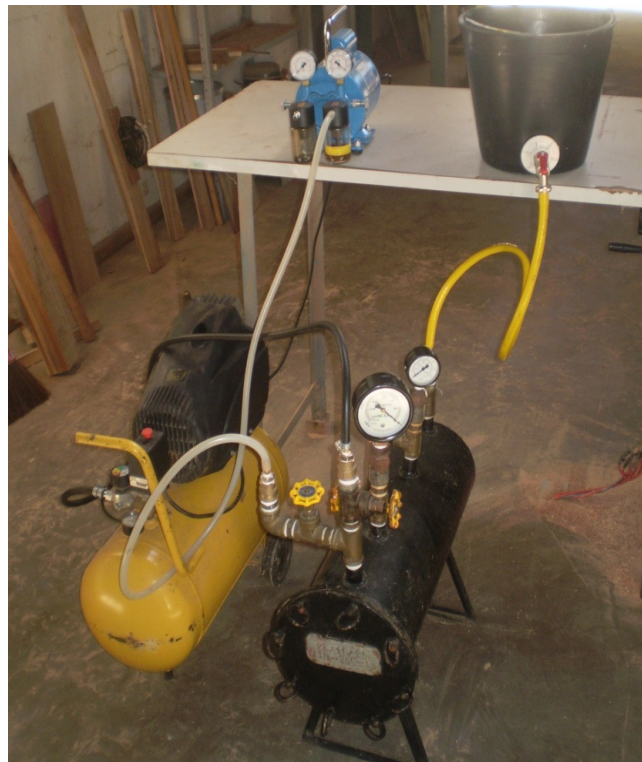
Figura 2 - Autoclave-piloto empregada para o tratamento da madeira.
