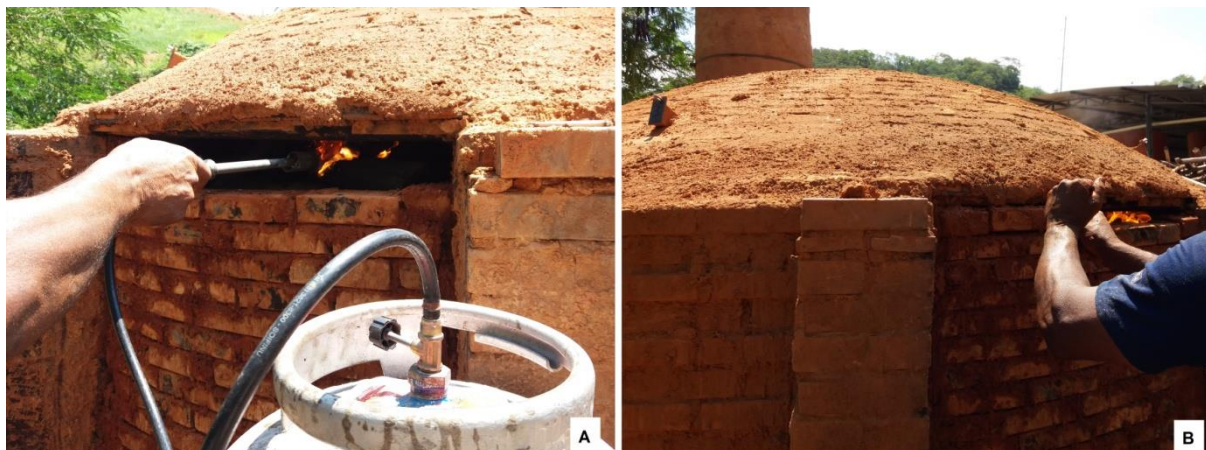
Figura 3 – A) Ignição da carbonização com maçarico. B) Fechamento da abertura da porta.
