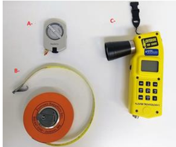
Figura 7 – Equipamentos utilizados para coletas de dados: A – Clinômetro de Suunto; B – Fita diamétrica e C – Criterion RD 1000.
