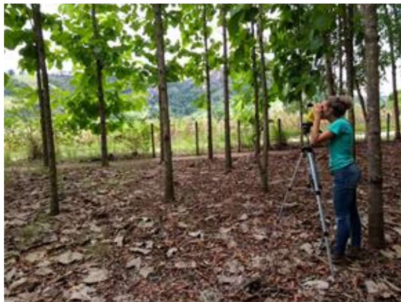
Figura 8 - Medição dos diâmetros nas alturas desejadas com o uso do Criterion RD 1000
