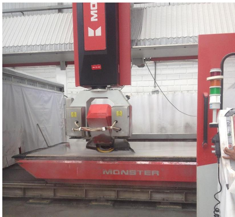
Figura 7 – Máquina de Comando numérico
