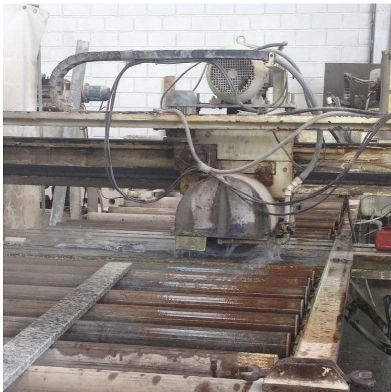
Figura 27 – Processo de umidificação.
