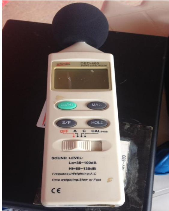
Figura 14 – Decibelímetro modelo DEC 460 da marca INSTRUTHERM.
