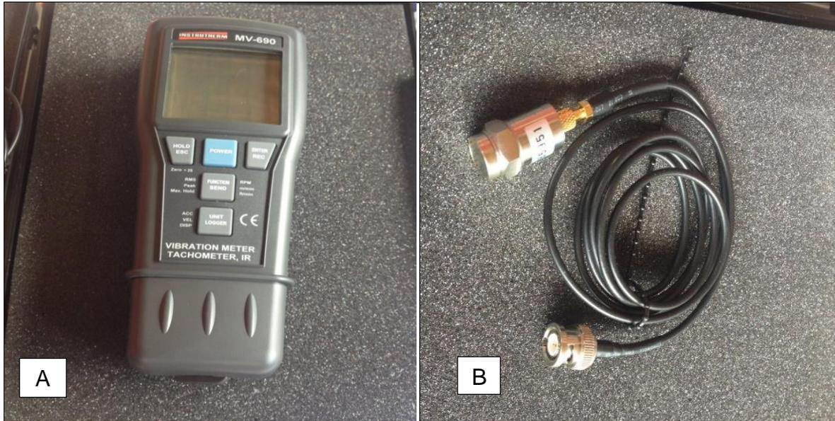
Figura 15 – A) Acelerômetro utilizado para a medição de vibrações;
