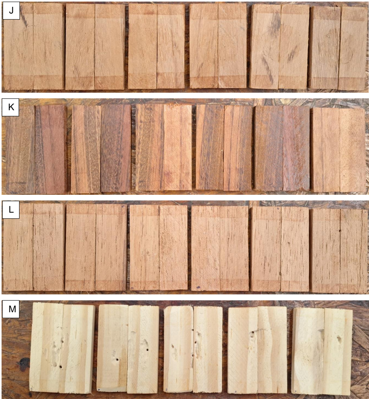
Figura 4: Análise de desgaste e número de orifícios da espécie Mangue (A), Amarelão (B), Angelim Pedra (C), Cedro Arana (D), Cumaru (E), Fava de Bolota (F), Ipê amarelo 1 (G), Ipê amarelo 2 (H), Ipê roxo (I), Jatobá (J), Muiracatiara (K), Cedro (L) e Pinus sp. (controle) (M). Fonte: A autora
