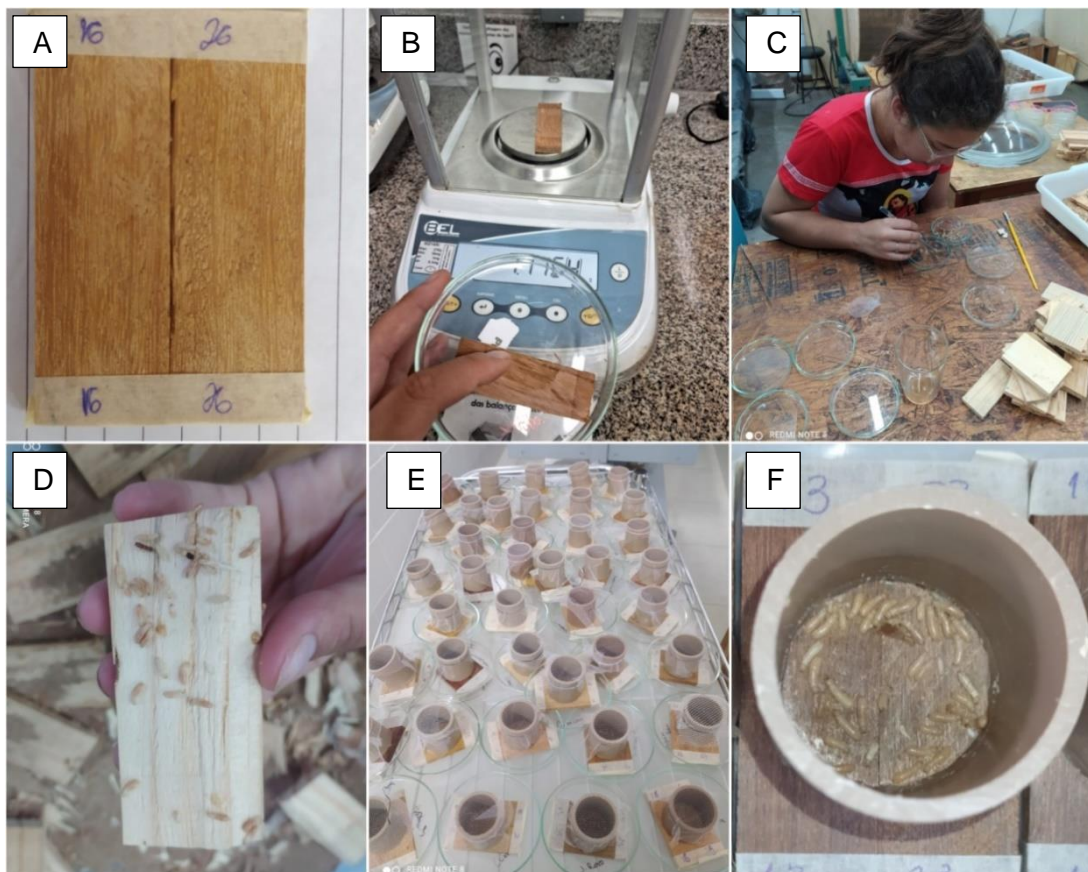
Figura 2: Corpos de prova unidos com fita ‘crepe’ (A), pesagem individual dos corpos de prova para obter a perda de massa (B), coleta de cupins saudios e jovens (C), local de coleta dos cupins (D), experimento montados (E) e térmitas já submetidos ao ensaio de alimentação forçada (F). Fonte: A autora
