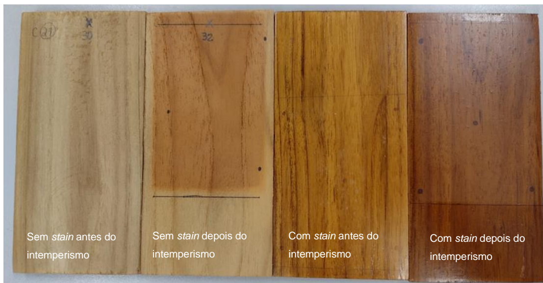
Figura 9. Amostras com e sem stain , antes e depois do intemperismo.
