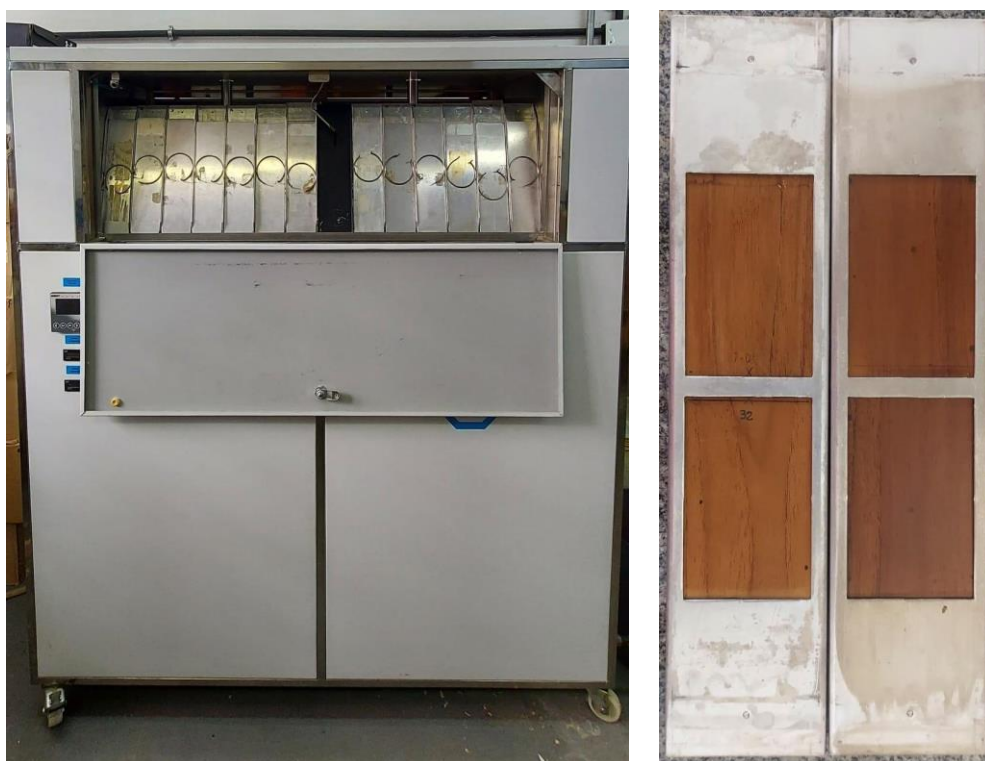
Figura 2. A) Máquina de ensaios de intemperismo acelerado; B) Corpos de prova com face ensaiadas.
