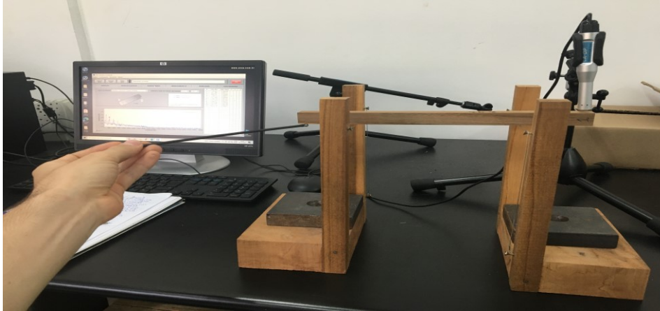
Figura 11 - Ensaio utilizando o método de propagação de ondas de excitação para a obtenção do modo de vibração torcional.
