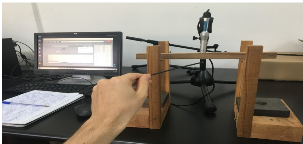
Figura 10 - Ensaio utilizando o método de propagação de ondas de excitação para a obtenção do modo de vibração flexional.
