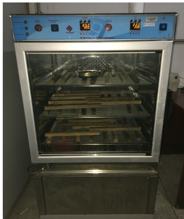
Figura 7 – Câmara climática QUIMIS Q315C21 com as amostras.
