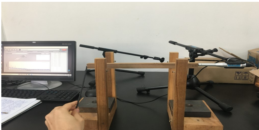
Figura 9 - Ensaio utilizando o método de propagação de ondas de excitação para a obtenção do modo de vibração longitudinal.
