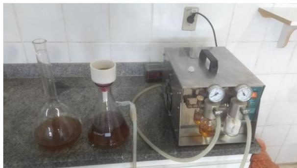
Figura 2 - Bomba de vácuo acoplada a um erlenmeyer de 2000 mL para extração das soluções. Fonte: O Autor.
