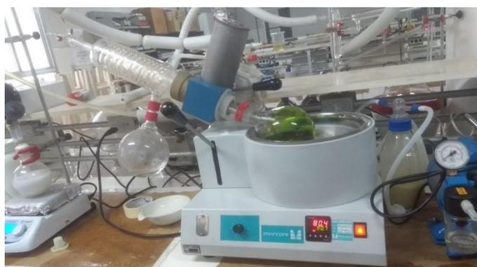
Figura 3 - Evaporador rotativo utilizado no experimento para concentrar os extratos. Fonte: O Autor.
