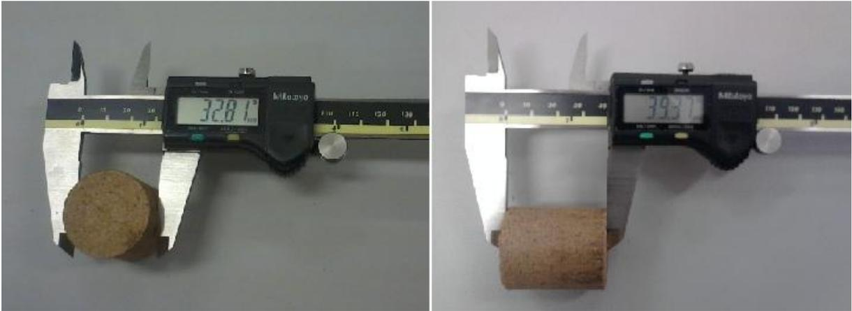
Figura 2 – Obtenção das medidas do diâmetro e comprimento dos briquetes de serragem.
