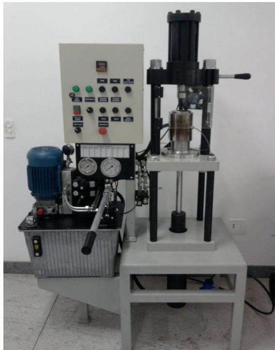
Figura 1 – Briquetadeira laboratorial da marca Lippel<sup>®</sup>, modelo LB-32.
