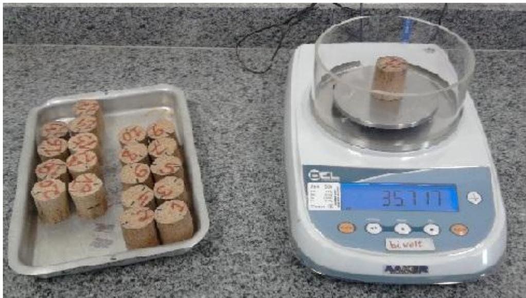
Figura 3 – Obtenção da massa dos briquetes de serragem.
