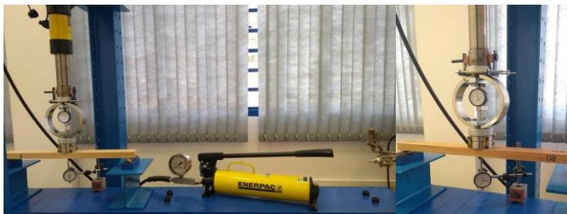
Figura 4 - Flexão estática nas lamelas.
