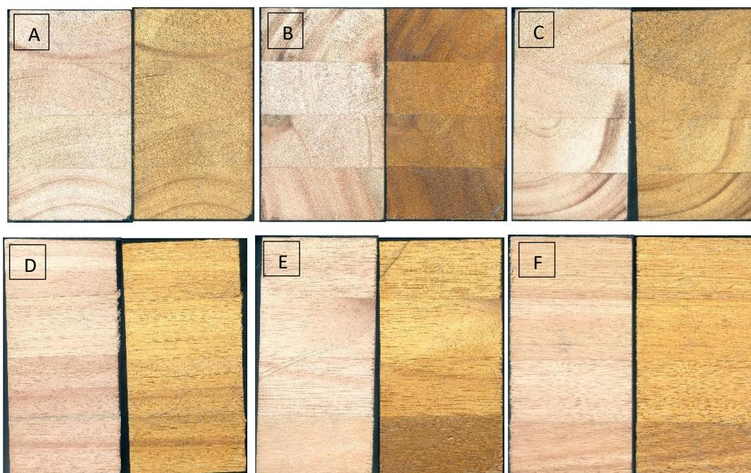
Figura 29 – (A) tratamento tangencial na seção transversal, (B) tratamento radial na seção transversal, (C) tratamento misto na seção transversal, (D) tratamento tangencial na seção longitudinal, (E) tratamento radial na seção longitudinal, (F) tratamento misto na seção longitudinal.
