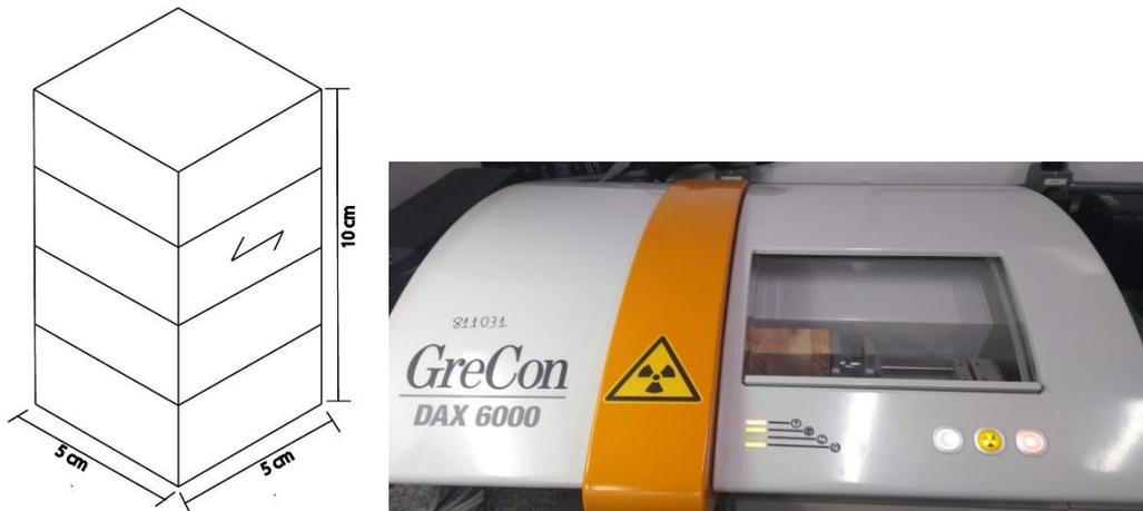
Figura 17 - Corpo de prova de raio x de microdensitometria e equipamento Fagus GreCon DAX 6000.
