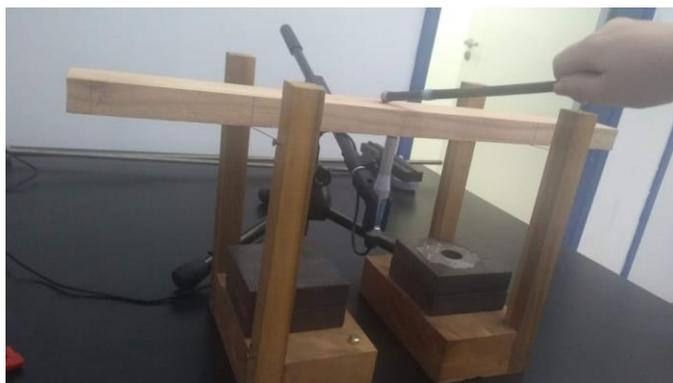
Figura 2 - Vibração transversal nas lamelas.
