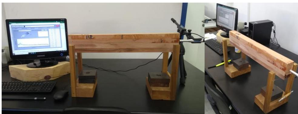
Figura 8 - Vibração longitudinal dos elementos de MLC.
