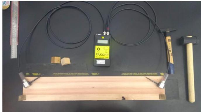
Figura 9 - *Stress wave* nos elementos de MLC.
