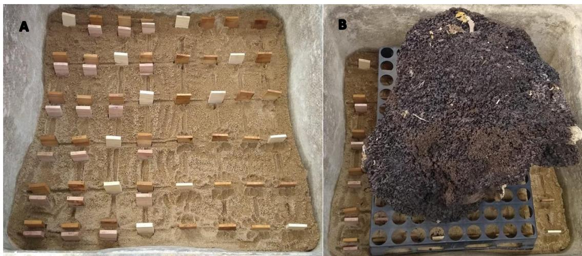
Figura 21 - Montagem distribuição das amostras (A); disposição da colônia de térmita para o ensaio de preferência alimentar (B).
