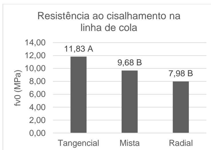
Figura 24 - Valores médios de resistências ao cisalhamento na linha de cola. Médias seguidas por mesma letra não diferem estatisticamente pelo teste de Tukey ( $p < 0,05$ ).
