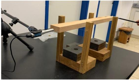
Figura 3 - Vibração longitudinal das lamelas.
