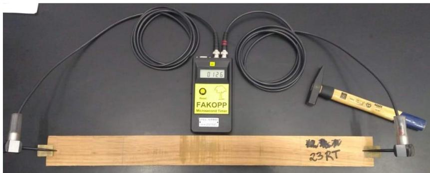
Figura 5 - *Stress wave* nas lamelas.
