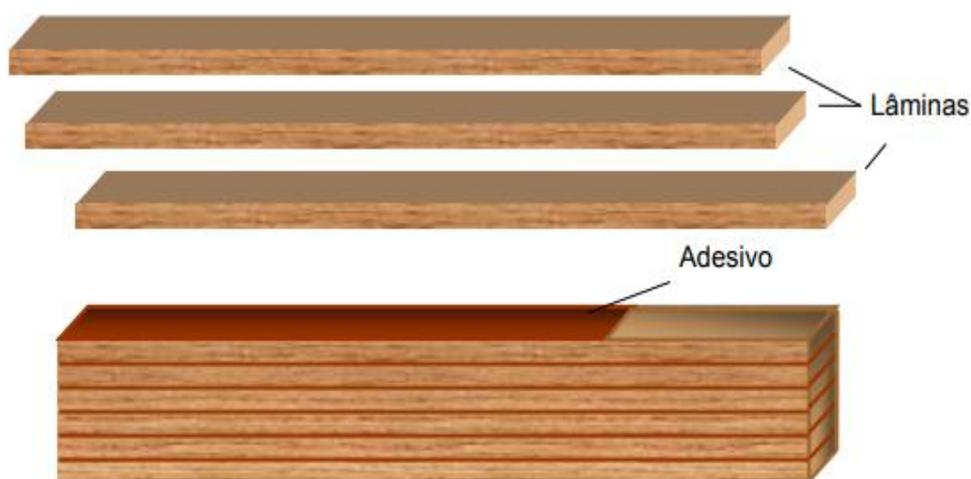
Figura 1 - Esquema de uma viga de MLC.
