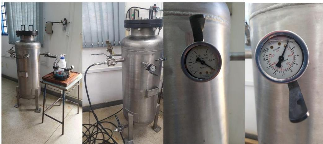
Figura 5 – Detalhes do equipamento utilizado para o ensaio de delaminação.
