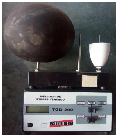
Figura 4 – Aparelho de IBUTG.
