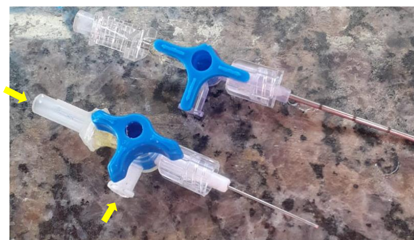
Figura 3 – Agulha coaxial utilizada para a confecção dos filamentos. A primeira seta à esquerda da imagem representa a entrada de MFC, e a seta abaixo, representa a entrada de GG e lignina.
