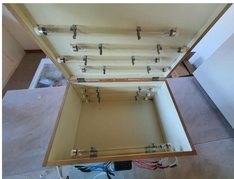
Figura 7 – Caixa para a exposição dos fios à luz ultravioleta.
