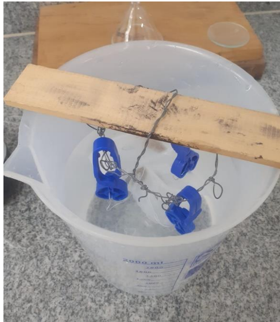
Figura 5 – Sachês de chá com filamentos particulados (0,2 g) mergulhados em água destilada.
