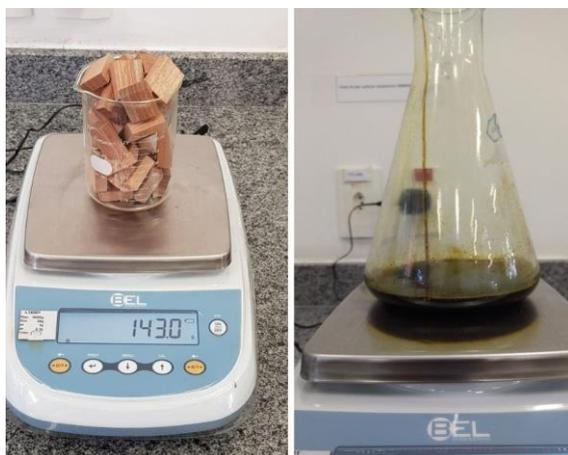
Figura 3 - Pesagem da madeira utilizada na carbonização e líquido pirolenhoso.
