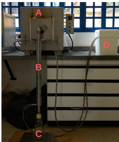
Figura 2 - Sistema de forno mufla montado para pirólise. A = Forno Mufla, B= Condensador, C = Coletor de líquido pirolenhoso, D = Sistema de refrigeração do condensador utilizando caixa térmica e bomba hidráulica.
