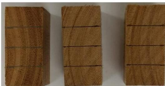
Figura 1 - Amostras de madeira marcadas para confecção dos corpos de prova.
