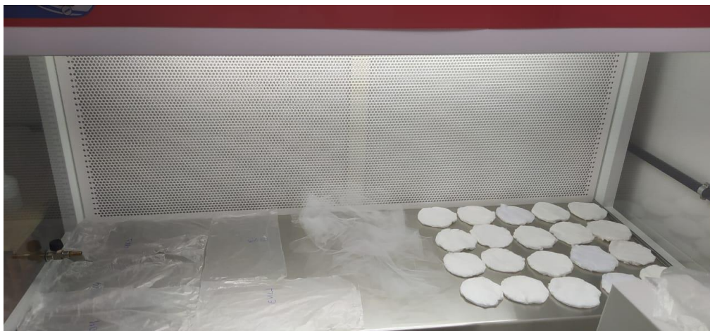
Figura 16: Esterilização das mantas filtro de algodão em câmara de ultravioleta. Fonte: O Autor (2022).
