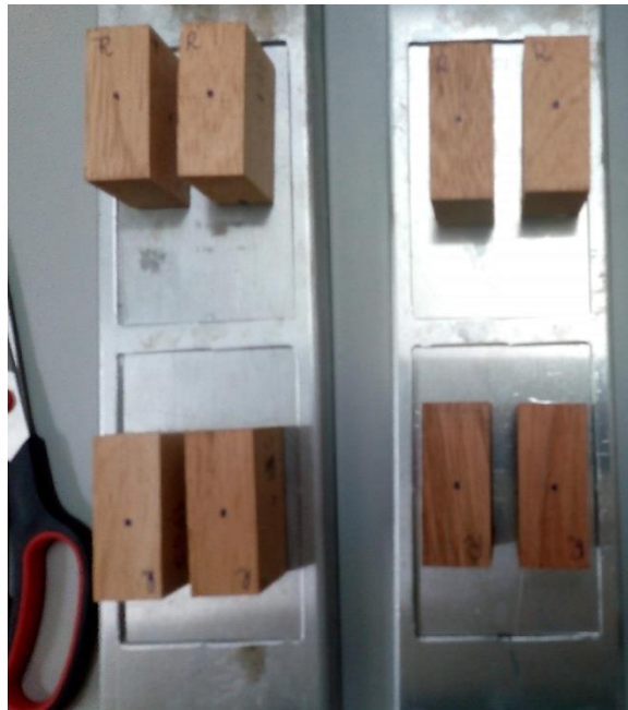
Figura 9 – Amostras de densidade, estabilidade dimensional e umidade dispostas no suporte da máquina de envelhecimento.
