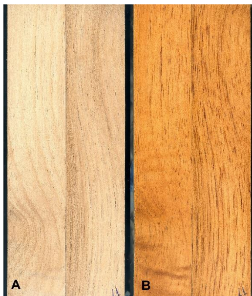
Figura 12 – Peças de madeiras coladas lateralmente com adesivo epóxi formando os corpos de prova, antes (A) e depois (B) da aplicação do stain .
