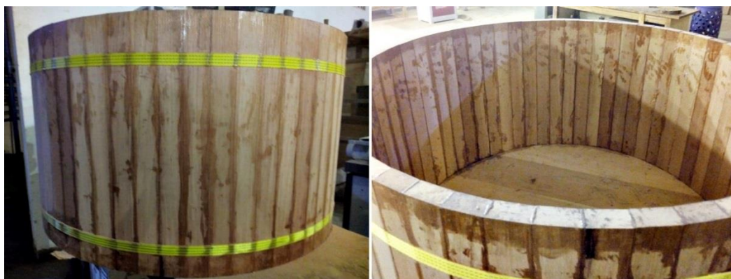
Figura 26 – Ofurô após a colagem das peças e com manchas causadas pela cola. Fonte: O autor (2019).
