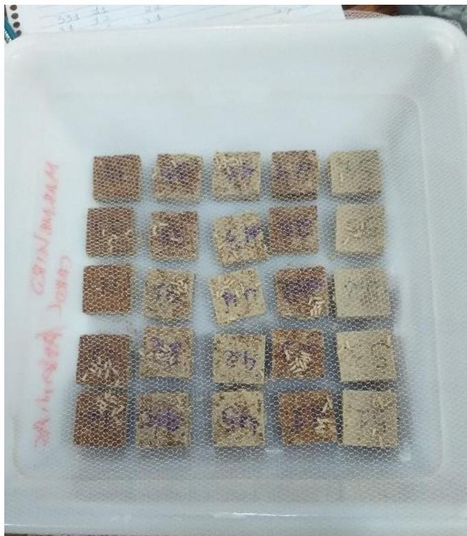
Figura 9. Disposição dos corpos de prova e térmitas na bandeja.
