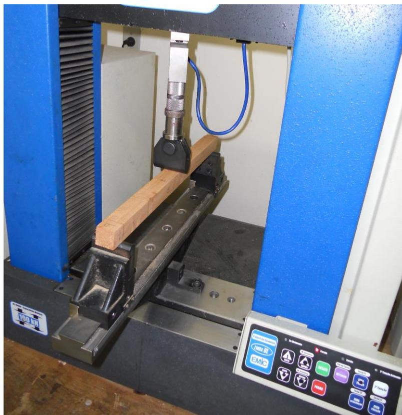
Figura 7 – Ensaio de flexão estática.
