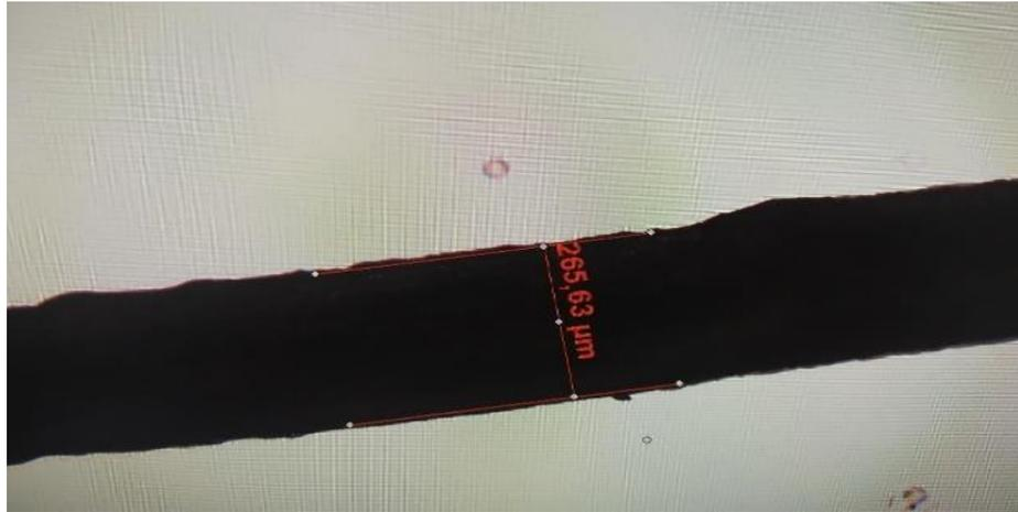
Figura 8: Imagem microscópica da medição dos filamentos
