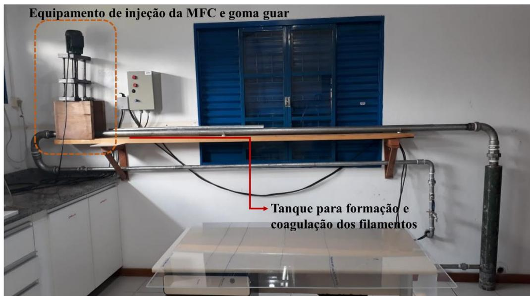
Figura 2: Equipamento utilizado para produção e coagulação dos filamentos e mesa de acrílico para secagem dos fios.
