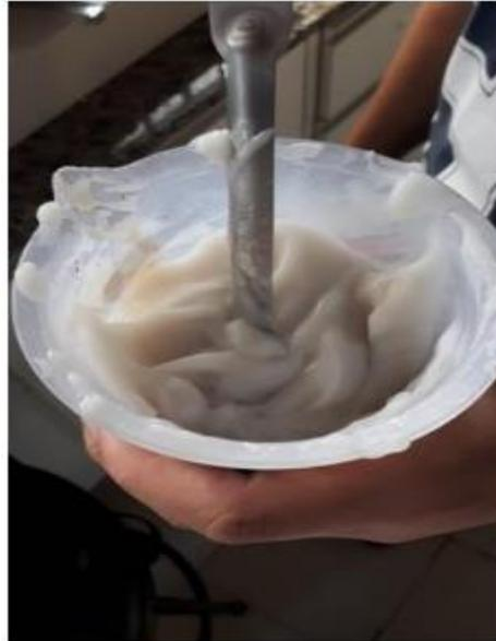
Figura 3: Mistura de Microfibrilas de celulose (MFC) e goma guar (GG) utilizada pra produção dos fios monocomponentes.
