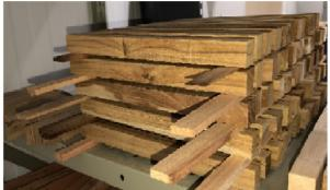
Figura 1: Corpos de prova de flexão antes do ensaio.
