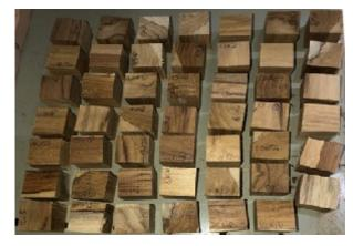
Figura 3: Corpos de prova de dureza antes do ensaio.
