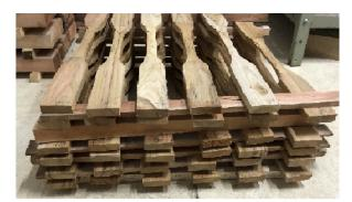
Figura 4: Corpos de prova de tração paralela às fibras antes do ensaio.
