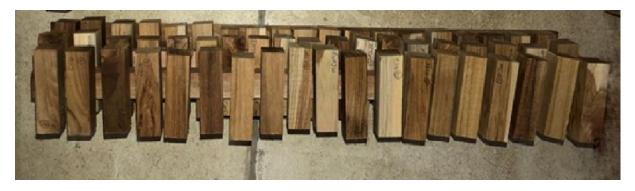
Figura 2: Corpos de prova de compressão antes do ensaio.
