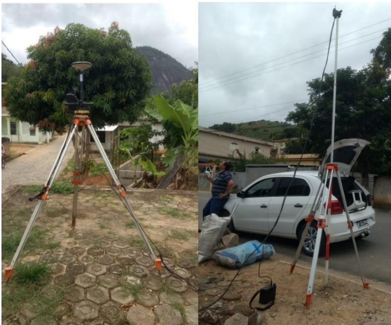
Figura 7. Base para correção dos pontos para georreferenciamento.
