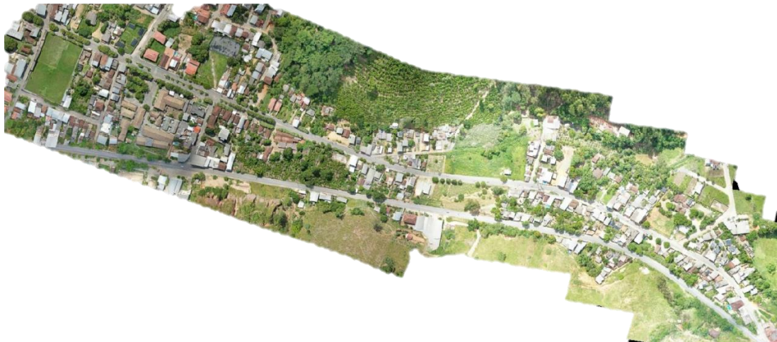
Figura 14. Imagem obtida após o processamento das imagens do RPA.
