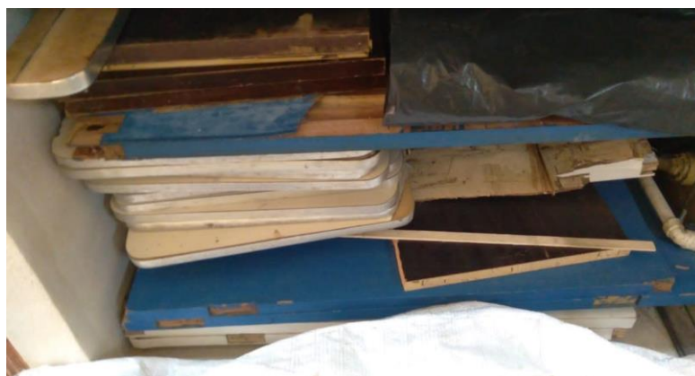
Figura 8. Artigos de madeira com infestações de cupins usados para confecção do ensaio. Fonte: O autor.
