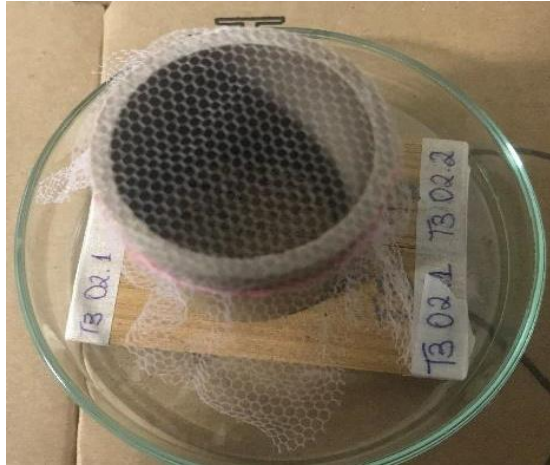
Figura 9. Representação do ensaio de cupim de madeira seca com tubo policloreto de vinila (PVC) e tecido “filó”. Fonte: O autor.
