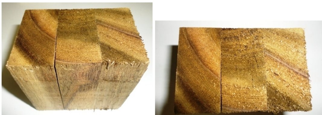
Figura 16 – Corpos de prova após ensaio de delaminação apresentando falha na linha de cola.
