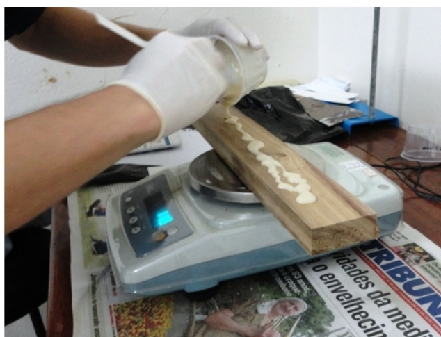
Figura 1 – Aplicação do adesivo na superfície das lâminas.
