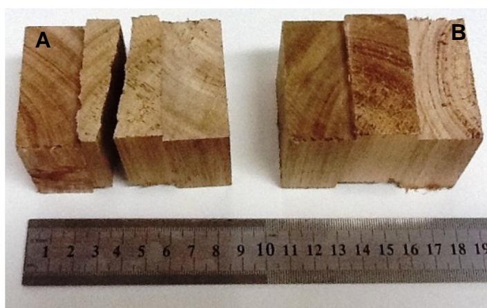
Figura 13 – Corpos de prova do tipo 'H', rompido na madeira (A) e intacto (B).
