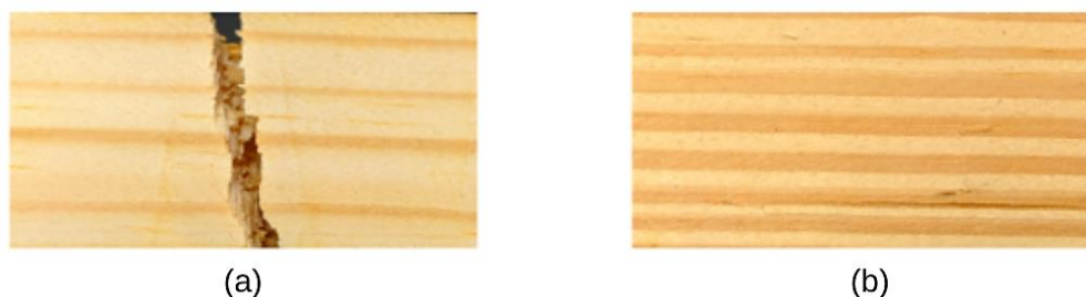
Figura 4 - Amostra de imagens com superfície rompida (a) e sem superfície rompida (b)
