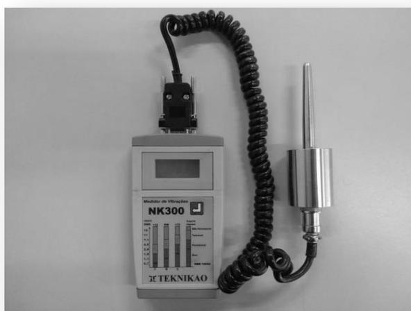
Figura 3. Acelerômetro e medidor de vibração.
