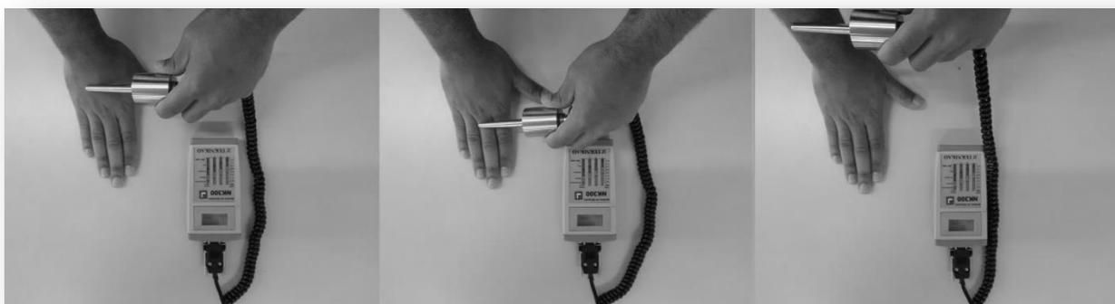
Figura 4. Coordenadas ortogonais ISO 5349-1. A: eixo xx; B: eixo yy; e C: eixo zz.
