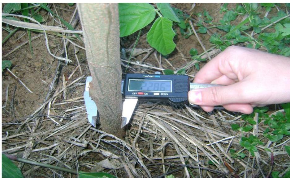
**Figura 5.** Medição do diâmetro do coleto com paquímetro digital.
