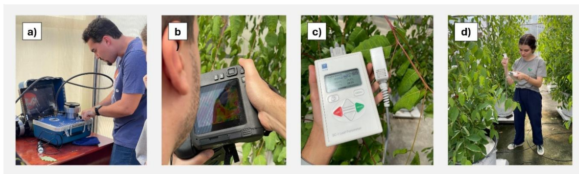
Figura 7 - Análises dos parâmetros do (a) potencial hídrico foliar ao meio-dia, (b) fotografia da temperatura da folha com a câmera termográfica, (c) e (d) condutância estomática utilizando porômetro em Jerônimo Monteiro, Espírito Santo, Brasil.
