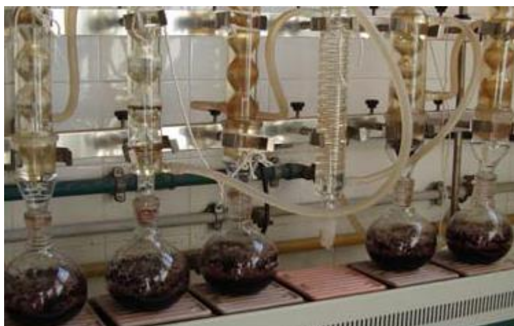
Figura 1. Extração laboratorial em manta térmica sob sistema de condensação.
