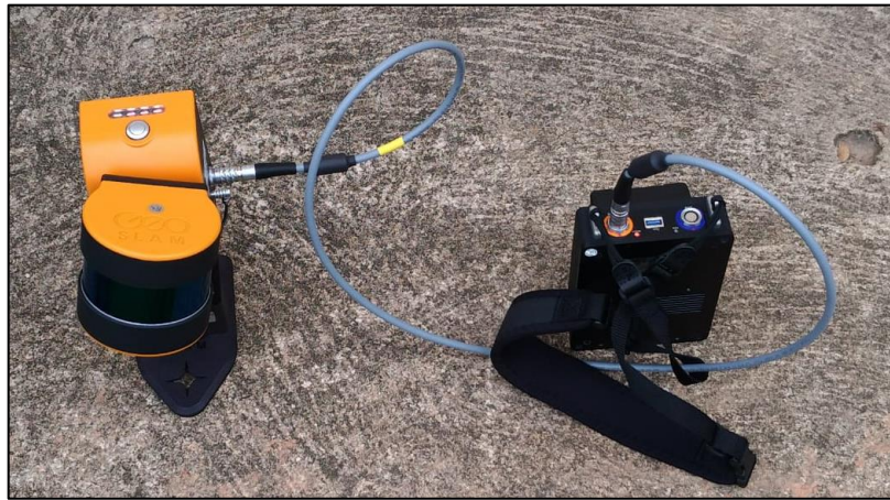
Figura 6 - Equipamento laser scanner ZEB Horizon utilizado na obtenção das informações deste estudo. Fonte: Autora (2021).
