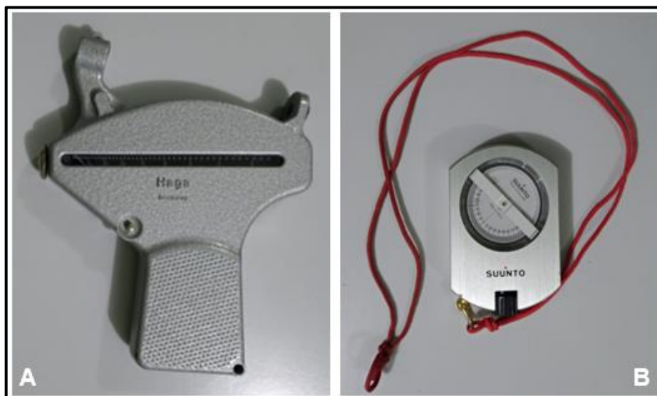
Figura 4 - Equipamentos Hipsômetro de Haga (A) e Hipsômetro portátil Suunto PM5 – 1520D (B) utilizados na obtenção das alturas das árvores.
