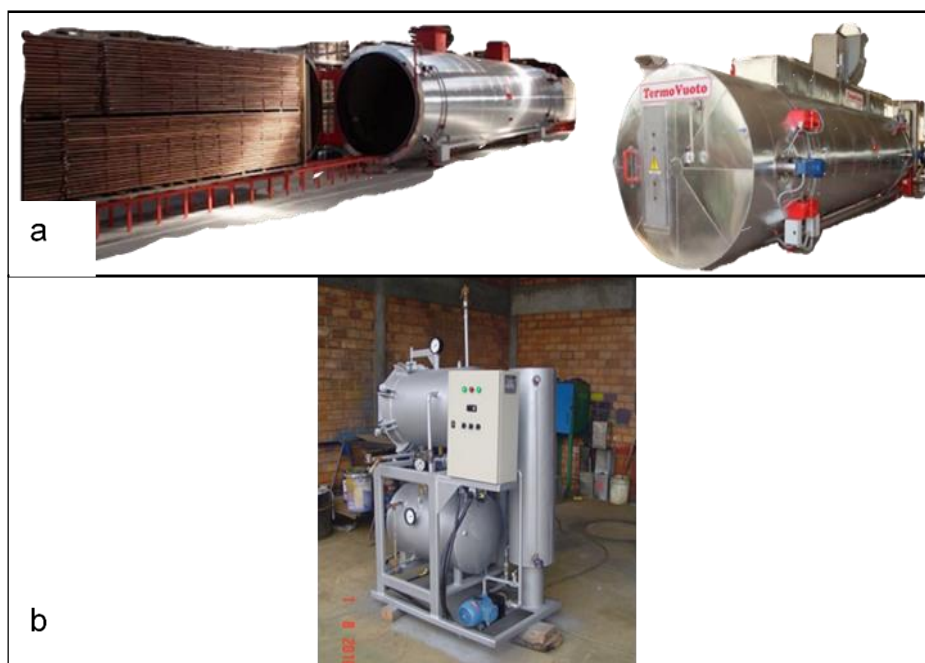
Figura 1 – Equipamentos para modificação térmica da madeira: a) Industrial; b) Laboratorial.
