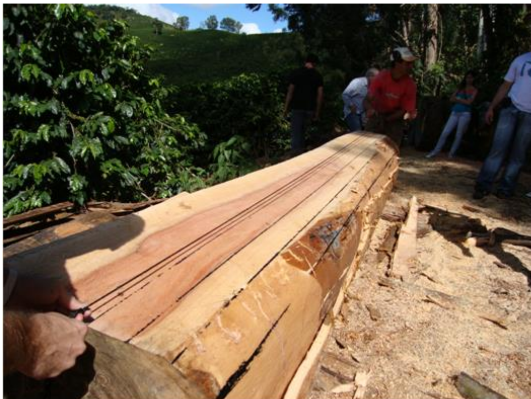
Figura 4 – Delimitação para a retirada das últimas costaneira e do produto final Fonte: O autor (2010).
