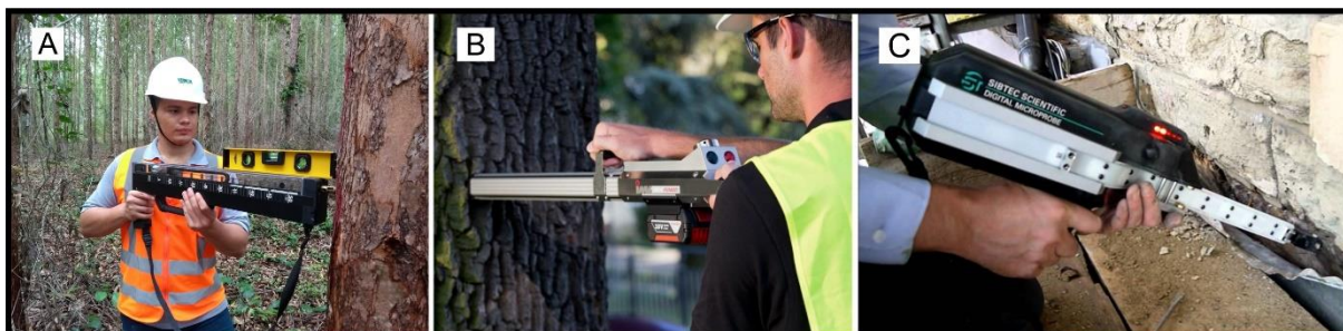
Figura 1 – Equipamentos que utilizam a metodologia de resistência à perfuração (Drilling Resistance). A – Resistograph®; B – IML-RESI Systems; C – microsonda digital.
