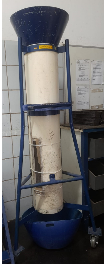
Figura 1 – Equipamento medidor de densidade a granel produzido e adaptado pela empresa. Fonte: A Autora (2022).
