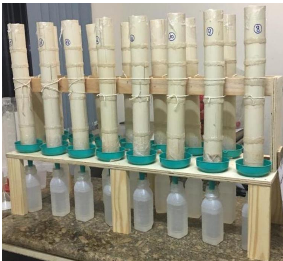
Figura 1 - Colunas de PVC de 40 cm fixadas em suporte e sob funis que conduzem o lixiviado para as garrafas coletoras. Fonte: Autora (2019).
