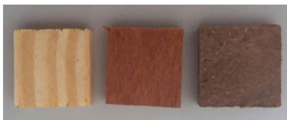
Figura 6 – Corpos de prova para o ensaio de alimentação forçada.
