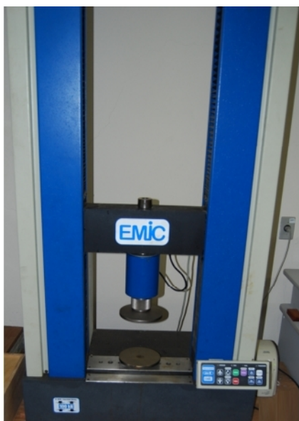
Figura 9 – Máquina de ensaio mecânico com aquisição automática de dados
