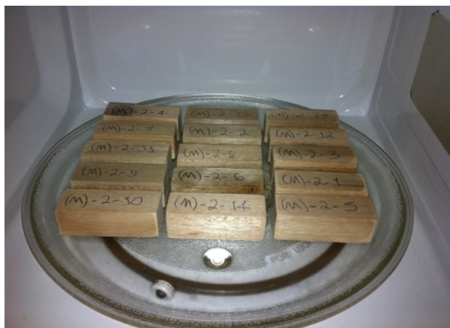
Figura 11 – Amostras tipo E – 1.1 do primeiro grupo no arranjo físico utilizado no aparelho de micro-ondas
