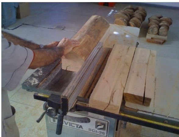
Figura 3 – Preparação dos corpos de prova E – 1.1 e E - 1.2 para ensaios de resistência à compressão axial e módulo de elasticidade dinâmico
