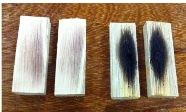
Figura 5 – Pirólise em amostras submetidas a inadequados layouts iniciais
