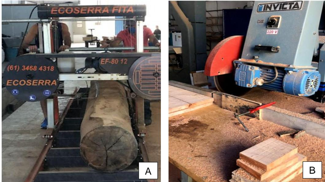
**Figura 2** – A: Serragem das toras; B: Serragem das taboas.
