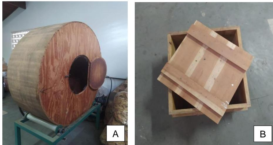
**Figura 5** – A: Encoladeira; B: Caixa formadora de madeira.
