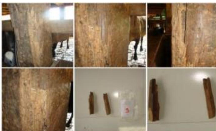
Figura 11 – Processo de retirada das amostras
