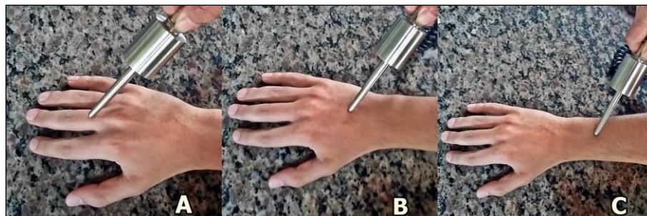
Figura 4. Coordenadas ortogonais ISO 5349-1. A: eixo xx; B: eixo yy; e C: eixo zz.
